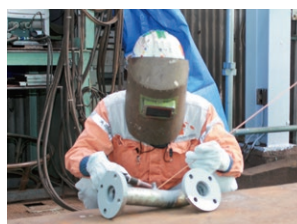
部下に手本を示しTIG溶接の 技能を伝承
