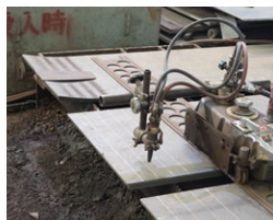
夏・冬で鉄板の温度が違うため、ガスバーナーを当てる温度を調整。試験でも生かすことができました
