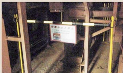
2スクリーン以外のスクリーンにもポールとリングバーによる応急対策を施しているが、恒久的な対策として2スクリーン同様に安全柵での危険防止措置をとる必要がある。しかし、設置箇所が多く、改善完了までに時間と費用がかかるため、追加の応急対策について検討した。
