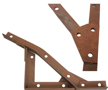
一級の実技試験では課題を見てから図面を 描き、鉄板を切り、2つのパーツを組み合わ せ、Lのアンクルを製作
