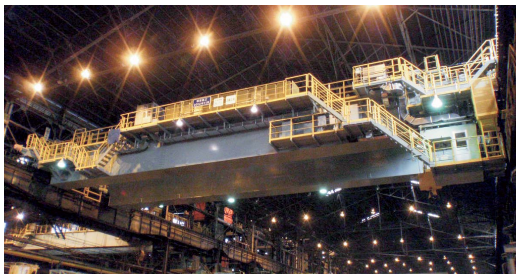
機械装置設計グループ実績写真 旋回フック付35t/15t天井クレーン
