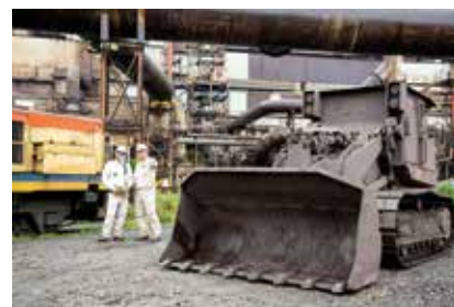
▲転炉の下で使用 する無線重機の 運転操作を指導 中(写真右)
