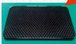
▲炭素繊維でできた薄いシートを重ねて真空密閉。プラスチック樹脂を流し込み、24時間置いて固めると、CFRPが完成します。
