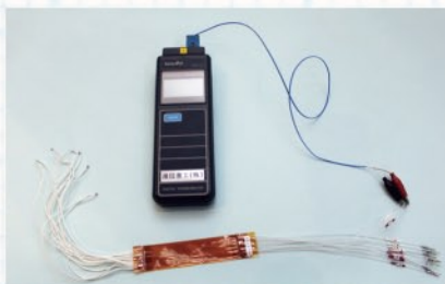
▲デジタルサーモメーターは熱電対の先端に番号が 付いており、その番号ごとに温度を表示しています。
