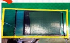
▲炭素繊維でできた薄いシートを重ねて真空密閉。プラスチック樹脂を流し込み、24時間置いて固めると、CFRPが完成します。
