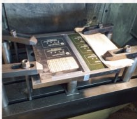
▲専用加工装置でCFRPを加工。CFRP製の名刺を製作しました。完成品は高級感があります。
