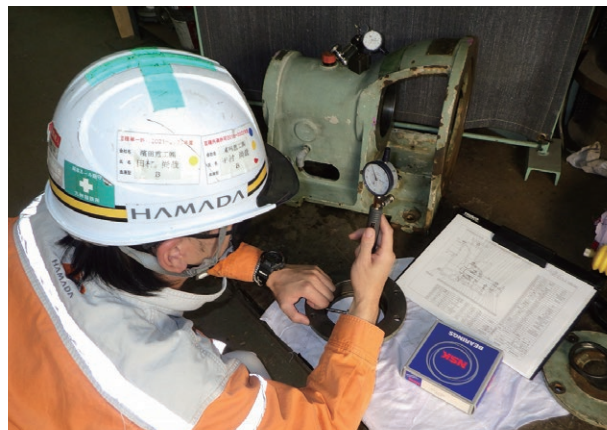
機械部品の寸法をダイヤルゲージを使って測定
