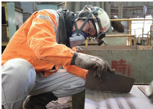
ガスバーナーで加熱して水で冷やしながらか調整する“はな曲げ加工”も精度が大切
