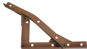
課題どおりに図面を描き、鉄板を切り、2つのパーツを組み合わせてLアングルを製作。開けた穴がきちんと合うことと、製作物が縦に立ち、倒れないことが合格の条件です
