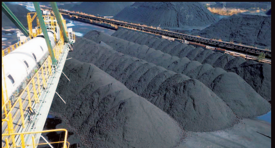
スタックホイローダの最大の利点は、スタッカとリクレーマという両方の機能を備える点で、2台で行う作業が1台でできます。
