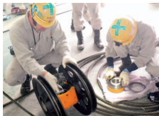
20tクレーンフックの整備作業中
