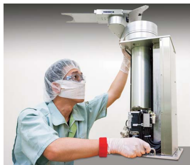
生産設備に使用されているウェハー搬送用ロボットのメンテナンス作業
